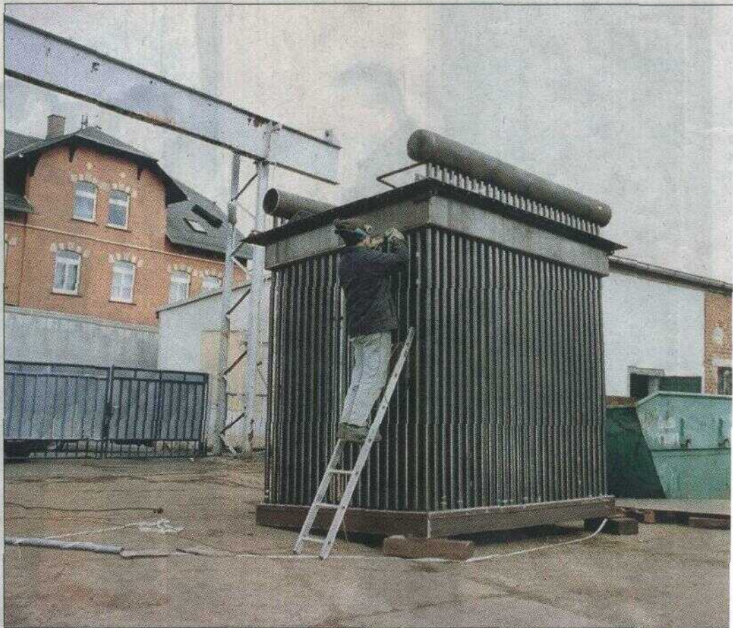
Den letzten Schliff verpasst Karsten Kober den Schweißnähten am Kontaktmaten.
