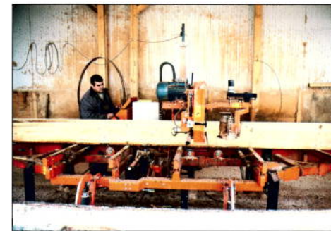
Два станка Wood-Mizer распиливают древесину из монастырского леса и делают строительный материал для восстановления храмов
