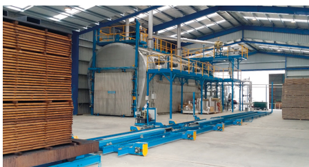
Стандартная печь Jartek для термической модификации пиломатериалов
